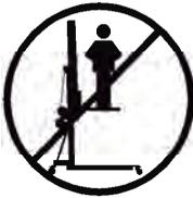
**3.1** - La torre elevadora TE-076 es una máquina diseñada para la elevación de cargas en dirección vertical. NUNCA se debe utilizar como plataforma elevadora de personas.
