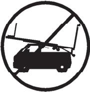
**3.13** - Antes de transportar la torre, todos los tramos deben ser bajados, y las patas deben extraerse y colocarse en su posición de transporte.
