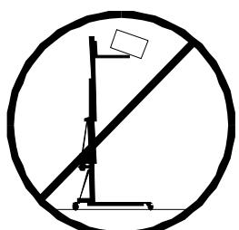
**3.4 - Ne pas éléver si la charge n'est pas correctement centrée sur l'attachement de manutention de charge.**
