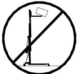
**3.4 -** Nunca se debe elevar una carga sin antes verificar que está correctamente apoyada y centrada en los soportes elevadores adecuados, de forma que el peso de la carga sólo actúe en sentido vertical.
