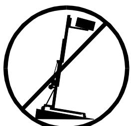
**3.2 - Placer le pied sur une surface dure et horizontale.**
