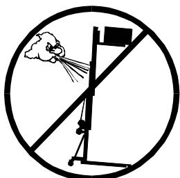
**3.6 -** Bei Freiluftanwendungen den Turm auf festen Boden stellen und mittels Seilanker gegen Windbelastung sichern. Niemals an Fahrzeugen die Abspannungen befestigen oder an Gegenständen, die ausweichen könnten.
