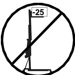
**3.14** - La carga mínima para un funcionamiento del freno sin problemas es de 25Kg. Sin esta carga mínima el freno no actuará.
