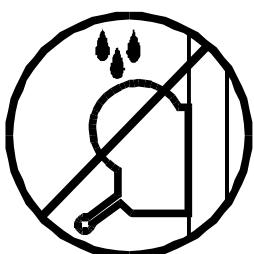
**3.15** - No engrase ni lubrique el mecanismo de freno del cabrestante. Los discos de freno, han sido engrasados con una grasa especial resistente al calor y la presión. No deben ser utilizados otros productos para evitar influir negativamente en el funcionamiento del freno.
