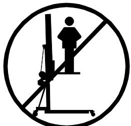
**3.1 -** El elevador TL-A150 es una máquina diseñada para la elevación de cargas en sentido vertical, NUNCA se debe utilizar como plataforma elevadora de personas.
