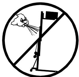
**3.6** - Si existe posibilidad de viento fuerte o en ráfagas, coloque el elevador en suelo firme y asegúrelo con la ayuda de tirantes. Nunca fije un tirante sobre un vehículo o cualquier otro elemento que pueda desplazarse.
