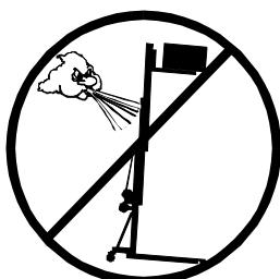
**3.6 - Ne pas manoeuvrer la machine durant un fort vent ou un vent en rafales. Ne pas laisser une charge en hauteur lorsque le vent peut se lever.**
