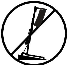
**3.2** - Den Lift nur auf harten und ebenen Flächen aufstellen und anhand der Wasserwaage (F) vertikal ausrichten. Bei Bedarf mittels des Stelltellers (Q) durch Drehen der Spindelkurbel (H) in entsprechender Richtung die Turmlage einstellen.
