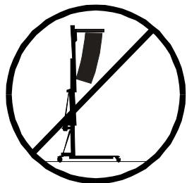
**3.4** - Niemals das Line Array anheben, bevor nicht sichergestellt ist, dass es korrekt am Lift befestigt ist.
