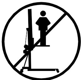
**3.1** - Der TL-A300 ist speziell für Line Array entwickelt worden und sollte niemals zum Heben von Personen genutzt werden.
