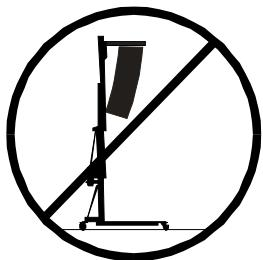
**3.4** - Nunca se debe elevar una carga sin antes verificar que está correctamente apoyada y centrada en los soportes elevadores adecuados, de forma que el peso de la carga sólo actúe en sentido vertical.
