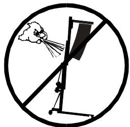
**3.6** - Bei stärkerem Wind den Turm auf festes Boden stellen und mittels Seilanker gegen die Windbelastung schützen. Niemals die Seilanker an einem Fahrzeug oder einem anderen beweglichen Gegenstand befestigen.
