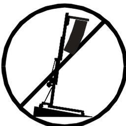
**3.2** - Colocar el elevador sólo en superficies duras y planas, verificando que está en posición vertical, mediante el nivel de burbuja (**F**) situado en el tramo base. Ajustar si fuera necesario con los platinos de apoyo (**Q**), girando la manivela (**H**) en el sentido adecuado. Nunca utilice cuñas ni elementos extraños para equilibrar el elevador.
