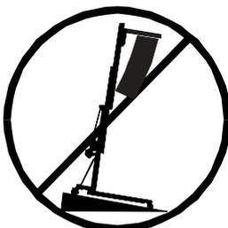
**3.2** - Den Lift nur auf harten und ebenen Flächen aufstellen und anhand der Wasserwaage (F) vertikal ausrichten. Bei Bedarf mittels des Stellellers (Q) durch Drehen der Spindelkurbel (H) in entsprechender Richtung die Turmlage einstellen.
