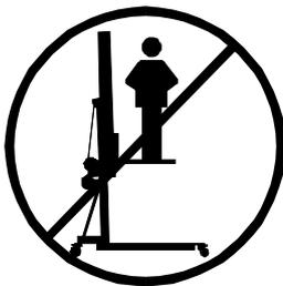
**3.1** - El elevador TL-A320 es una máquina diseñada para la elevación de cargas en sentido vertical, NUNCA se debe utilizar como plataforma elevadora de personas.
