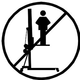
**3.1** - Der TL-A320 ist speziell für Line Array entwickelt worden und sollte niemals zum Heben von Personen genutzt werden.
